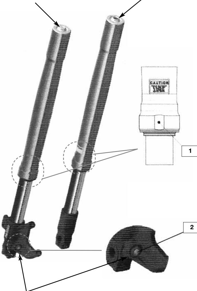
Regolazione idraulica in estensione.
